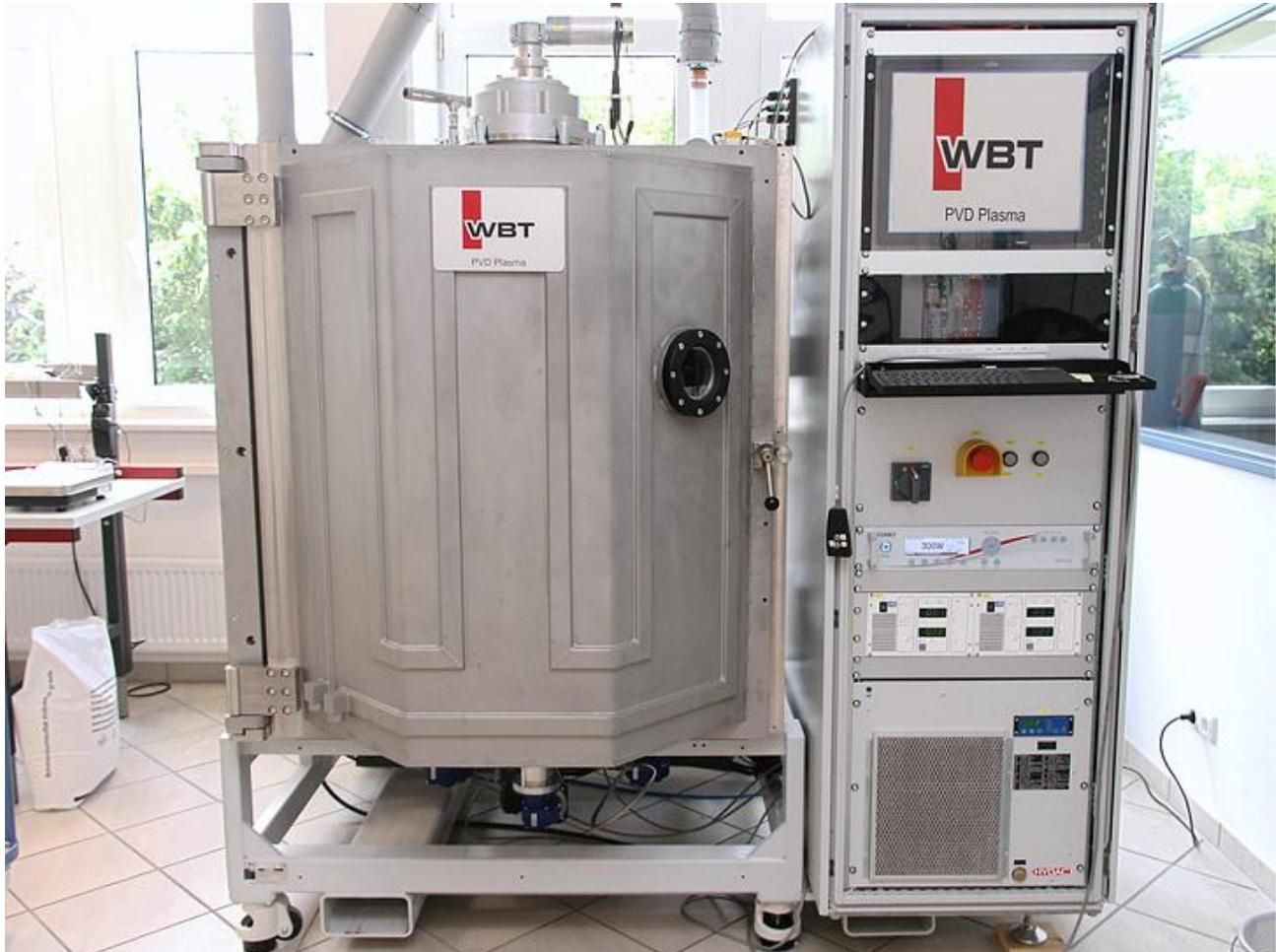
*Diese Maschine veredelt die hochreinen Kupferstecker mit einer hauchdünnen Schicht aus 24-karätigem Gold.*
