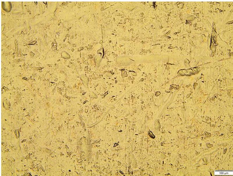
*Wird das Gold nach der Plasmaentladung atomar auf dem Stecker verteilt, ergibt sich deutlich sichtbar eine homogenere Oberflächenstruktur. (Bild: Prof. C. Burkhardt, HS Pforzheim)*
